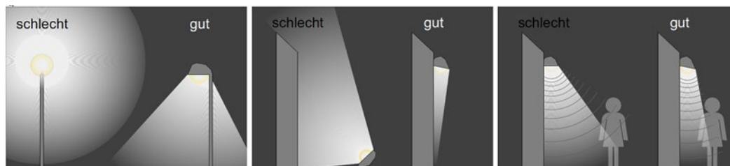
Beleuchtungsbeispiele (Quelle: Büro Faerber nach Przygoda)
