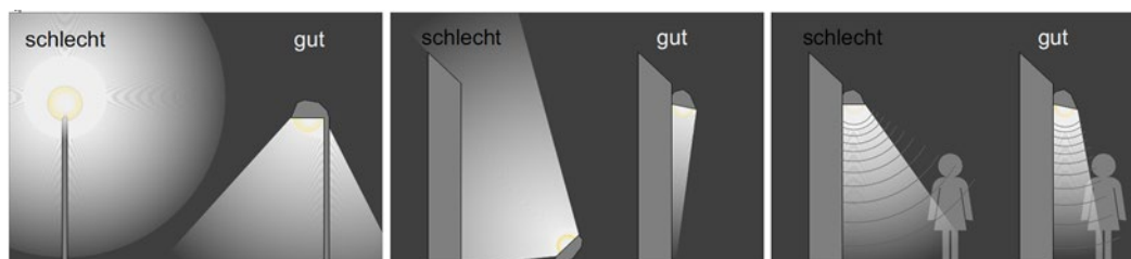
Beleuchtungsbeispiele (Quelle: Büro Faerber nach Przygoda)
